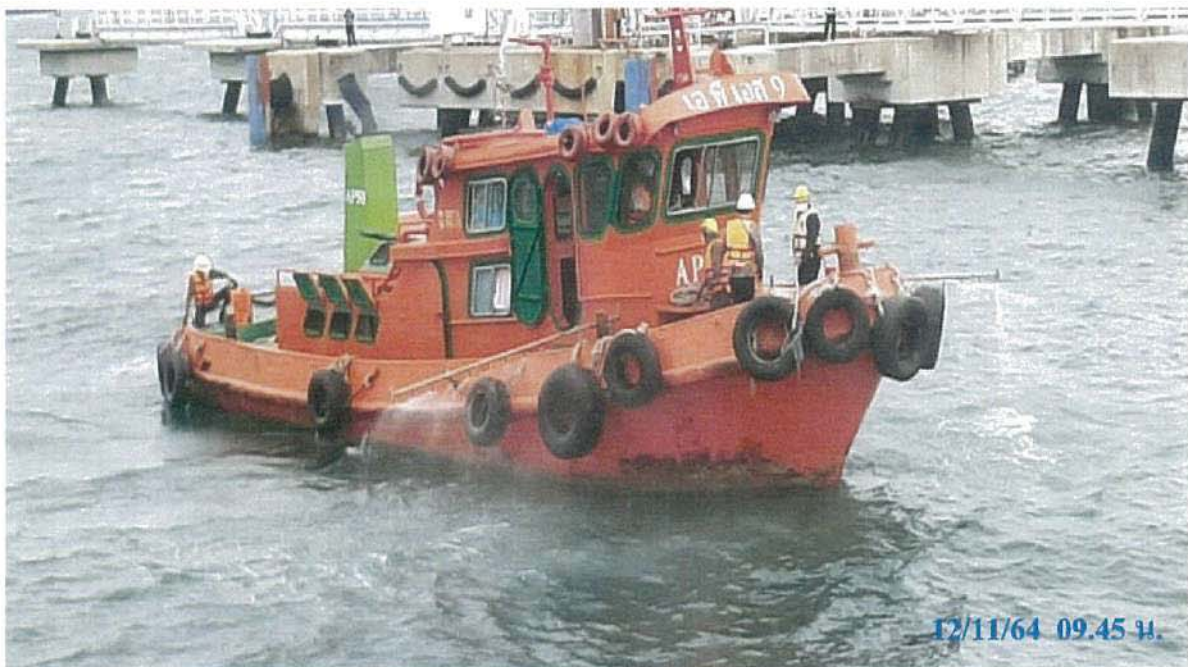
STT 15 ภาพแสดงเรือ TUG APS 9 วิ่งฉีดน้ำยาขจัดคราบน้ำมันบนผิวน้ำที่อยู่ภายนอก Boom ตามคำสั่งผู้สั่งการ
