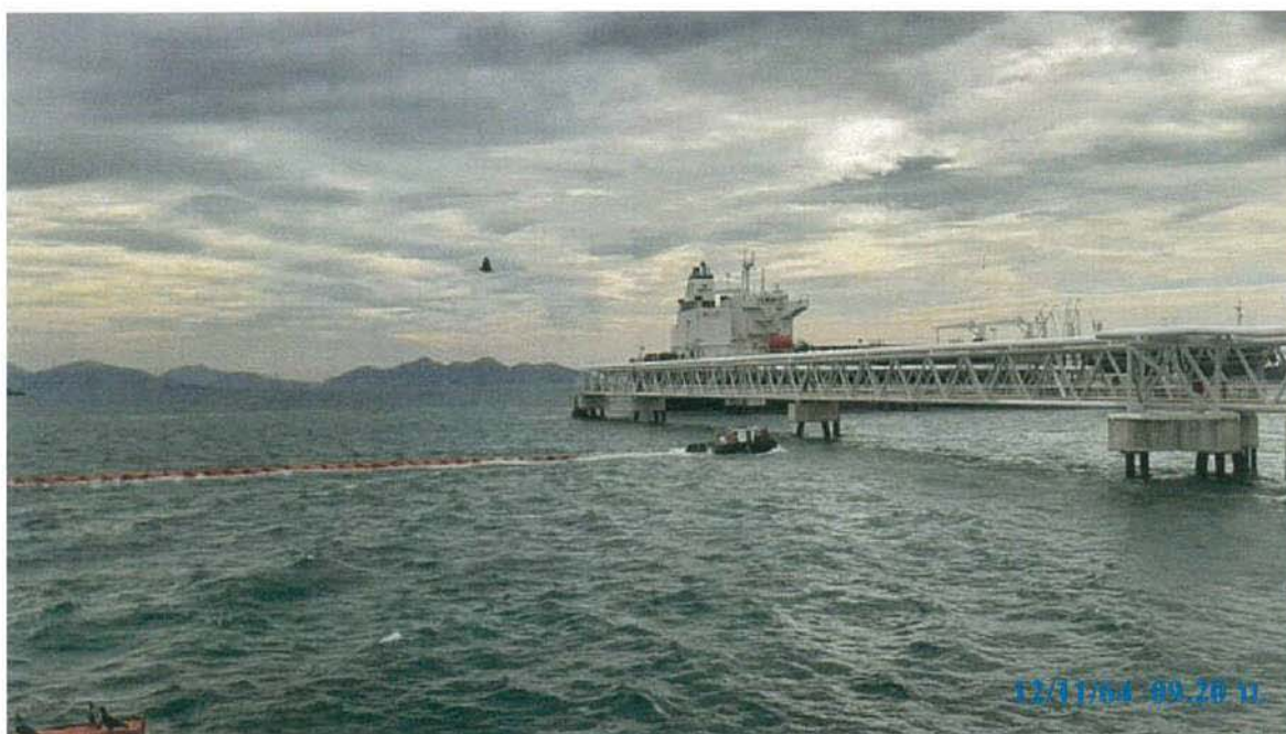
STT 3 เรือรับเชือกลาก BOOM ไปล้อมคราบน้ำมันตามคำสั่ง หัวหน้ากะ
