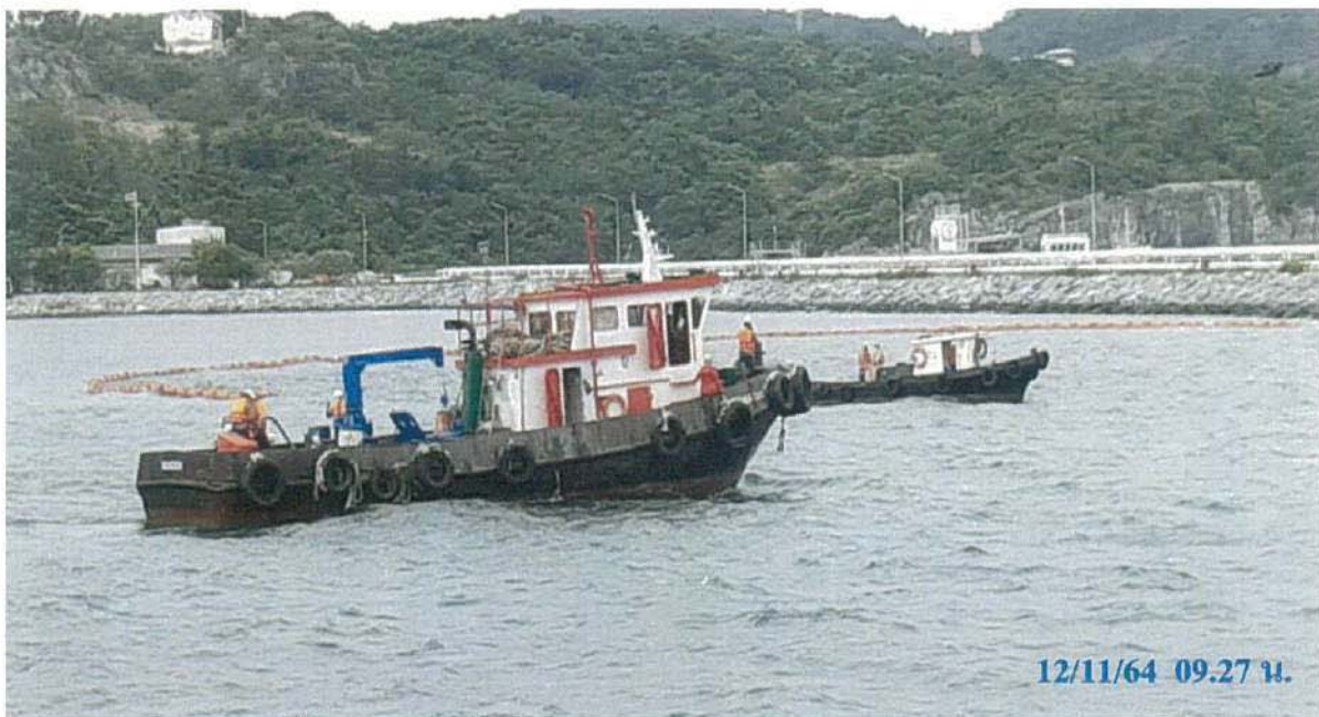
STT 11 เรือ ACS 2 พร้อมทีมขจัดคราบน้ำมัน และอุปกรณ์ วิ่งไปยังภายใน Boom เพื่อเก็บคราบน้ำมัน
