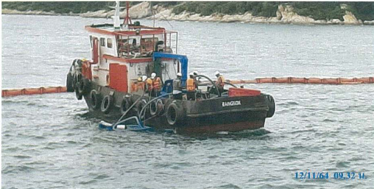
STT 12 ภายแสดงทีมขจัดคราบน้ำมัน ใช Disskimmer ดูดเก็บคราบน้ำมันบนผิวน้ำ เก็บใส่ถังบนเรือ
