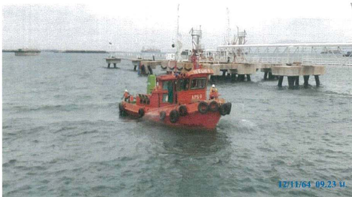
STT 6 ภาพแสดงเรือ TUG APS 9 ทำการฉีดน้ำยาขจัดคราบน้ำมันตามคำสั่งผู้สั่งการ
