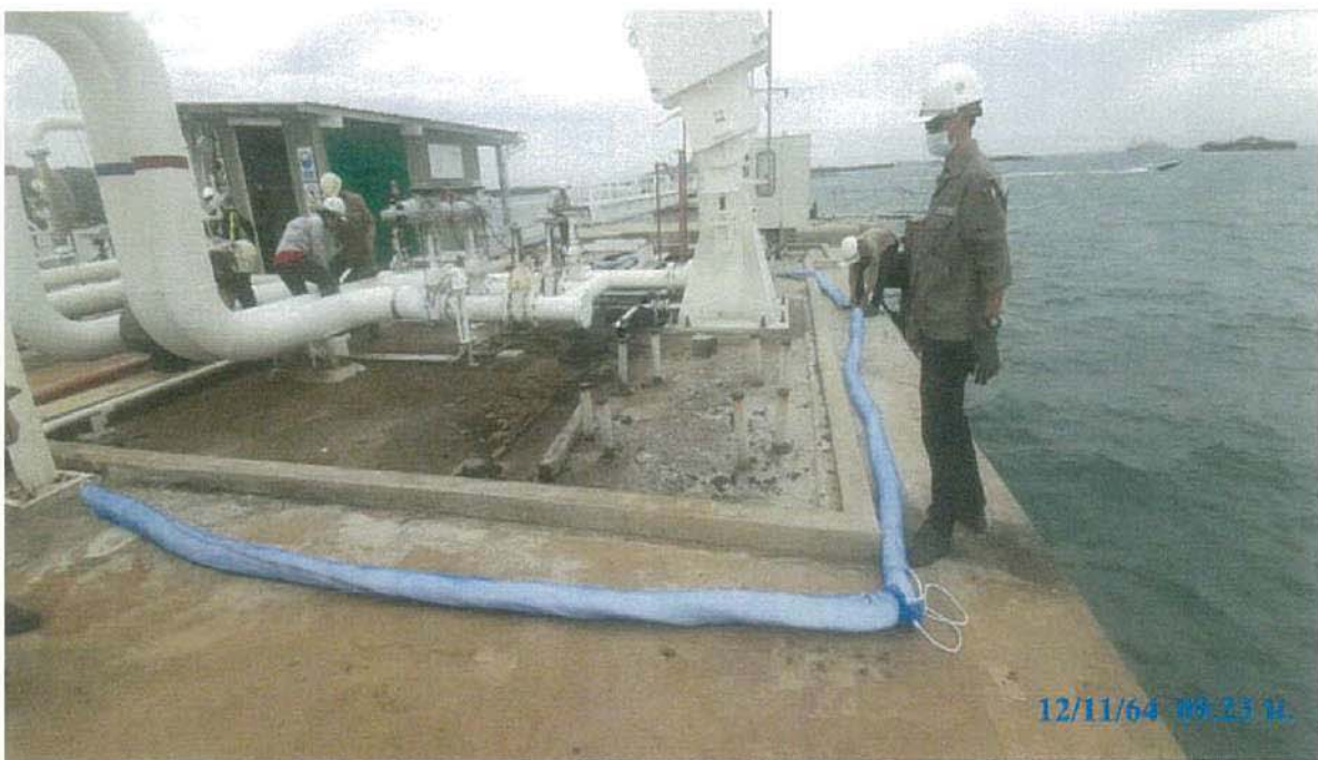
STT 8 ภาพแสดงการล้อม Oil sorbent boom ที่ Loading Plate Form ท่า 3
